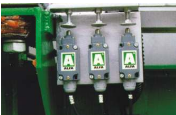
УСТРОЙСТВО ОГРАНИЧЕНИЯ ГРУЗОПОДЪЕМНОСТИ В СООТВЕТСТВИИ С ПРАВИЛАМИ ЕЕС
