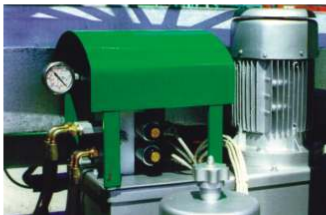
ГИДРАВЛИЧЕСКИЙ ПРИВОД С КЛАПАНАМИ И ДИСТАНЦИОННЫМ УПРАВЛЕНИЕМ
