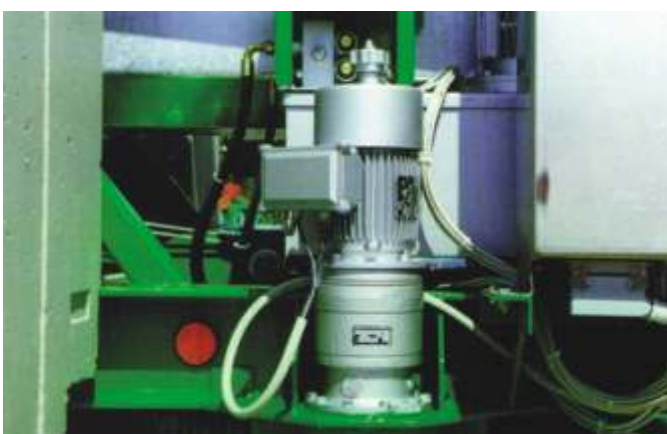
ПРЯМОЙ ПРИВОД ПОВОРОТА С ЭЛЕКТРОННЫМ УПРАВЛЕНИЕМ
