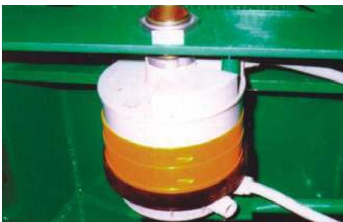
ТОКОСЪЕМНИК БЕЗ ОГРАНИЧЕНИЯ СКОРОСТИ ПОВОРОТА
