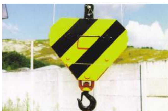
БЛОК-КРЮК ГРУЗОПОДЪЕМНОСТЬЮ 2,5 ТОНН ПРИ 2-КРАТНОЙ ЗАПАСОВКЕ ГРУЗОВОГО КАНАТА
