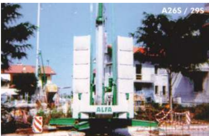
БЛОКИ ДОПОЛНИТЕЛЬНОГО БАЛЛАСТА МАССОЙ ПО 1000/1250 кг.
